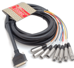
Figura 3-7: Esempio di cavo di raccordo DB25-to-XLR (venduto separatamente) per 8 canali d'ingresso e d'uscita AES/EBU. Questo cavo ha quattro connettori XLR femmina e quattro connettori XLR maschio. Per lo schema ved. Appendice D, "Schema dei cavi DB25-to-XLR" (pag. 111).
